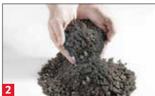
2 Optigrün-Extensivsubstrat Typ E (6 cm)
