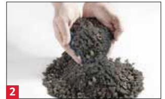
2 Optigrün-Extensivsubstrat Typ E (6 cm)
