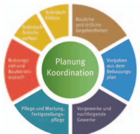
(2) Die Hauptfehlerquellen begrünter Dächer
